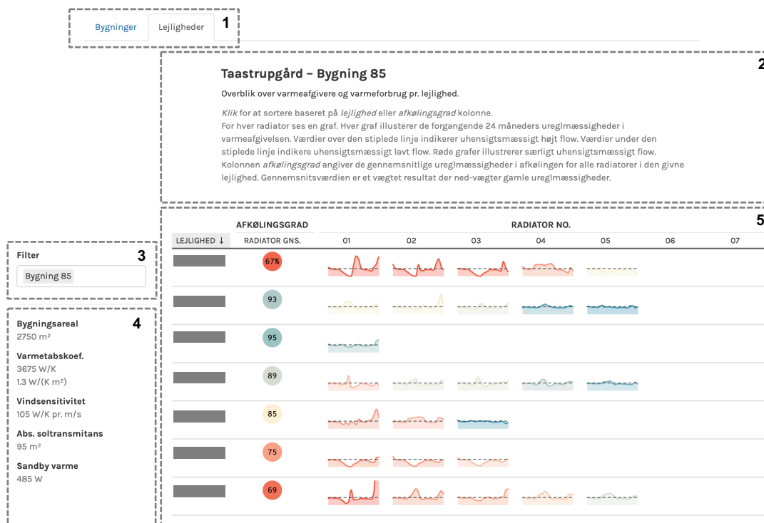
Figur 10: Illustration af webinterfacets side to af to til visning af estimerede termiske bygningsegenskaber og indikationer af radiator bidrag til optimal afkøling af fjernvarmevand.
